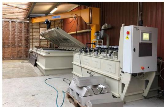
Cuve de décapage automatique fermée
